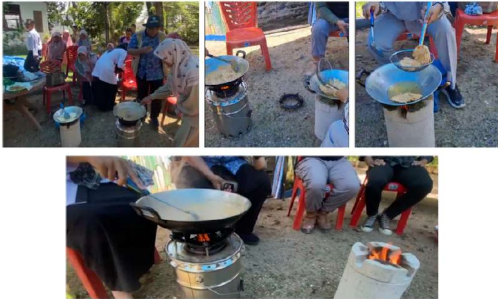
Gambar 4. Uji Coba Penggunaan Tungku Biomassa Berbahan Bakar Biopellet di Kebun Buah Kandi, Kota Sawahlunto, Provinsi Sumatra Barat
